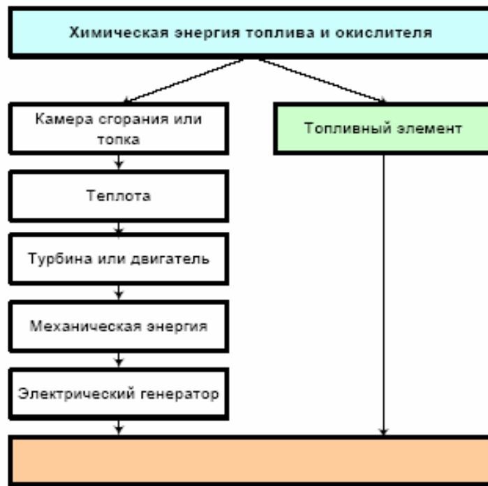
Рис. 3. Ступени преобразования химической энергии традиционным и электрохимическим способами
